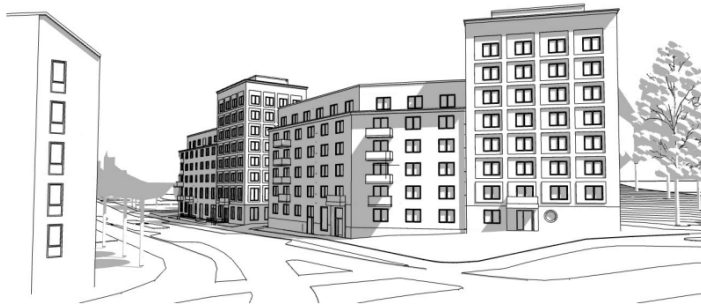
Bild 3. Björketorpsvägen, vy från söder. Volymerna består av fem våningar från gatan med en sjätte indragen våning för att bryta ned skalan och möta omgivande bebyggelse. Båda huskropparna avslutas med en högdal.
